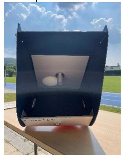
auf einen Spiegel gelenkt. Von dort aus wird das Bild der Sonne im Innern des Solarscopes an die Innenwand projiziert.
